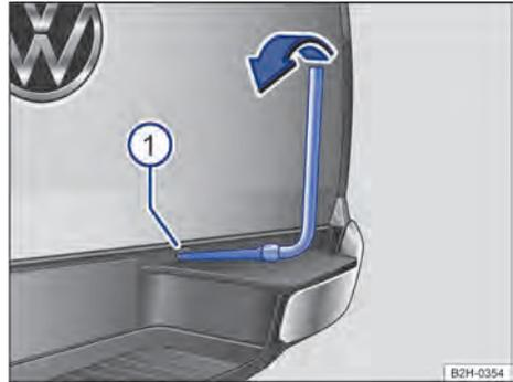
Fig. 205 Controlar el cable de elevación con el cabrestante.
