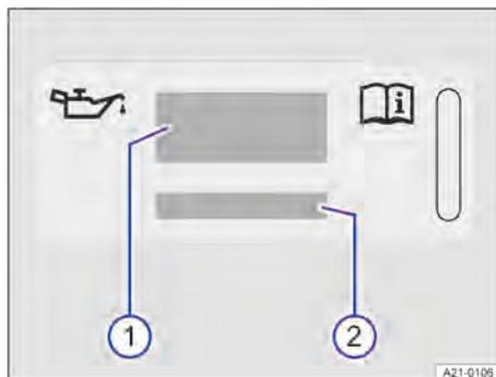
Fig. 185 Adhesivo con la norma y la viscosidad del aceite del motor (representación esquemática).
