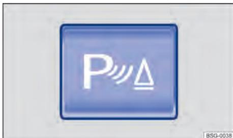
**Fig. 119** En la consola central: tecla para conectar y desconectar la ayuda de aparcamiento (en función del equipamiento).
