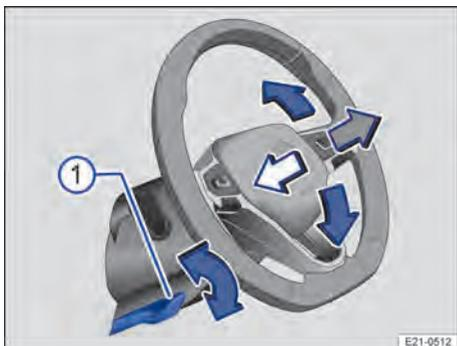
**Fig. 65** Debajo del volante, en el guarnecido de la columna de dirección: palanca para el ajuste manual de la posición del volante.
