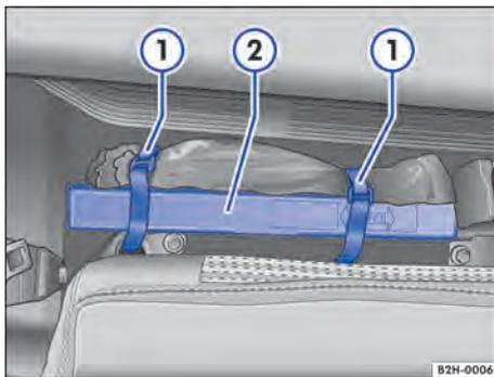
Fig. 56 Detrás del respaldo derecho del asiento trasero: triángulo de emergencia (2).
