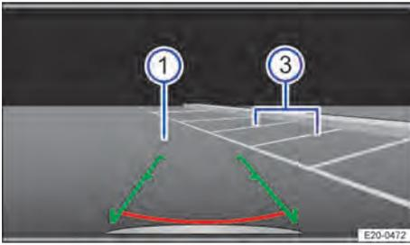
**Fig. 121** Visualización en la pantalla del sistema de infotainment: dirigirse hacia el hueco de aparcamiento seleccionado.
