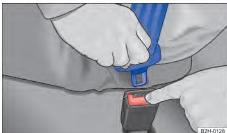
Fig. 36 Soltar la lengüeta del cierre del cinturón.
