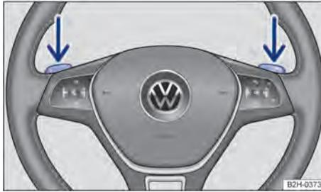
**Fig. 105** Volante con conmutadores basculantes del Tiptronic.
