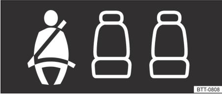
**Fig. 30** Indicador del estado de los cinturones de seguridad para los asientos traseros en la pantalla del cuadro de instrumentos.
