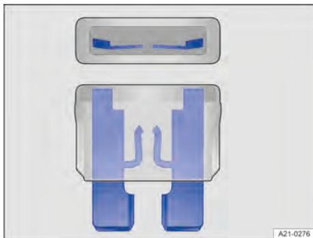
Fig. 171 Fusible fundido (representación esquemática).
