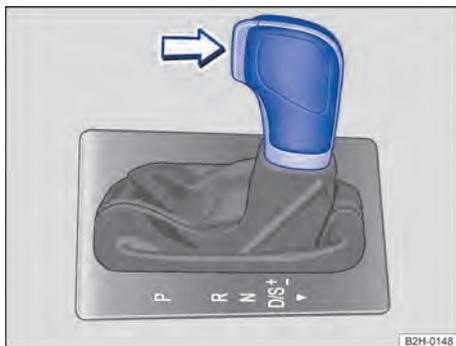
**Fig. 103** Volante a la izquierda: bieleta de selección con tecla de bloqueo (flecha). En vehículos con volante a la derecha, la disposición de los elementos es espejada.
