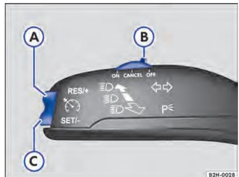
**Fig. 115** En el lado izquierdo de la columna de dirección: mando y teclas para manejar el regulador de velocidad.
