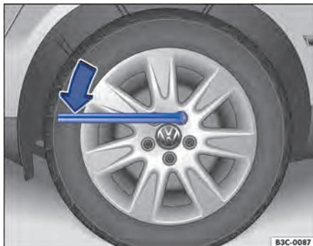
Fig. 202 Cambiar una rueda: aflojar los tornillos.
