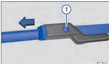
**Fig. 159** En el parabrisas: cambio de las escobillas limpiacristales del parabrisas.
