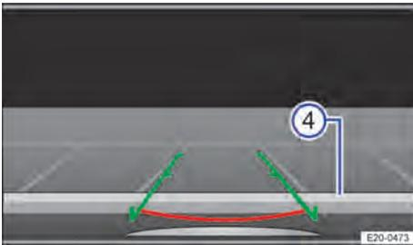
**Fig. 122** Visualización en la pantalla del sistema de infotainment: centrar el vehículo en el hueco de aparcamiento.
