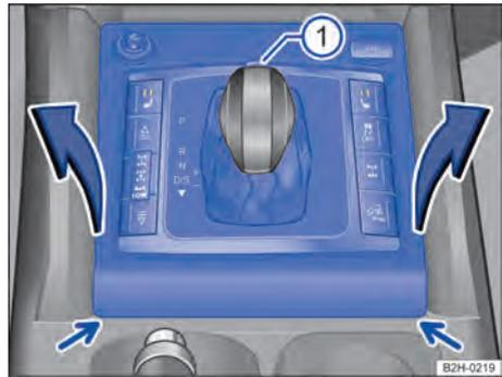
**Fig. 106** Desmontar la cubierta de la corredera de la palanca selectora.
