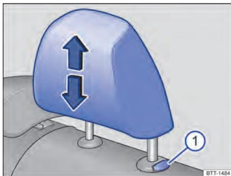
**Fig. 75** En las plazas laterales traseras: ajustar el apoyacabezas.
