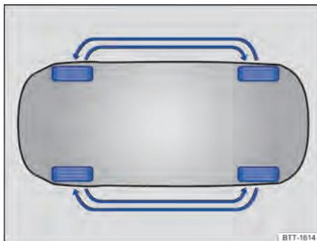
Fig. 196 Esquema para el intercambio de las ruedas.
