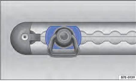
**Fig. 137** En la zona de carga: rail de amarre con argolla de amarre (representación esquemática).
