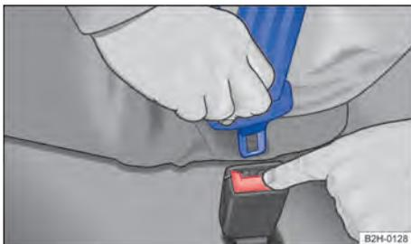
Fig. 34 Soltar la lengüeta del cierre del cinturón.
