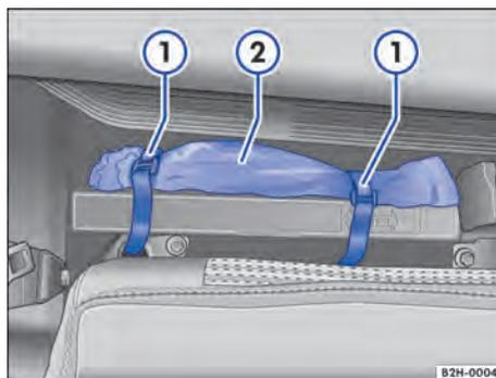
**Fig. 155** Detrás del respaldo del asiento trasero: bolsa con herramientas de a bordo.
