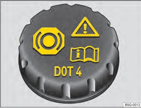
Fig. 192 En el vano motor: tapa del depósito del líquido de frenos.
