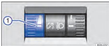
Fig. 86 Junto al volante: regulador de la iluminación de los instrumentos y los mandos.
