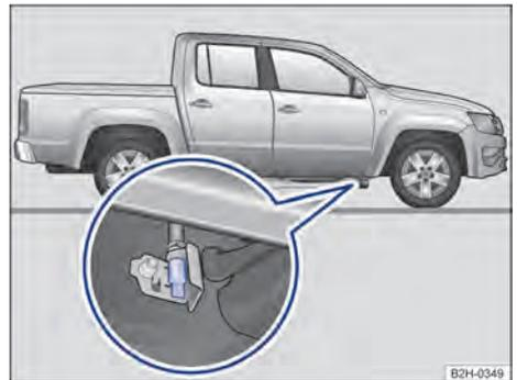
**Fig. 151** En los bajos del vehículo, en el larguero: tornillo de descarga del filtro del diésel (según el equipamiento).
