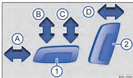
Fig. 68 Mando en el asiento delantero izquierdo: ajuste longitudinal, ajuste de la altura y de la inclinación de la banqueta, y ajuste del respaldo del asiento.
