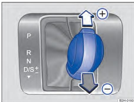
**Fig. 104** Palanca selectora en la posición Tiptronic (vehículos con volante a la izquierda). Vehículos con volante a la derecha son espejados.
