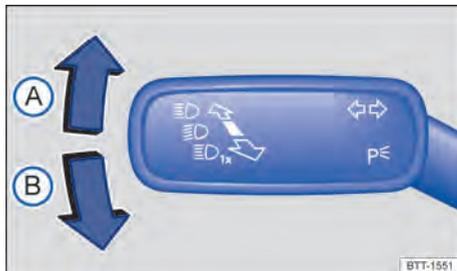
**Fig. 84** A la izquierda en la columna de dirección: palanca de los intermitentes y de la luz de carretera.
