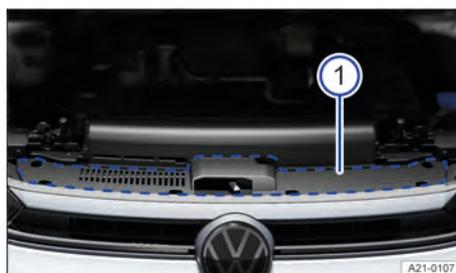
Fig. 186 Ubicación del adhesivo con la norma y la viscosidad del aceite del motor (representación esquemática).
