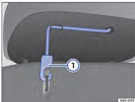
Fig. 70 Debajo del asiento trasero: cinta de sujeción de la banqueta.
