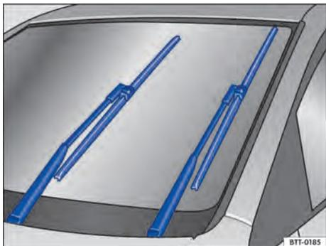
**Fig. 158** En el parabrisas: limpiaparabrisas en posición de servicio (representación esquemática).
