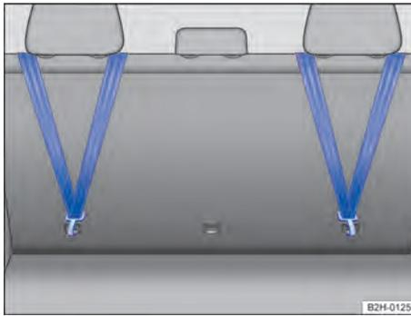
**Fig. 55** En la parte posterior del respaldo del asiento trasero: cinturón de fijación superior enganchado.
