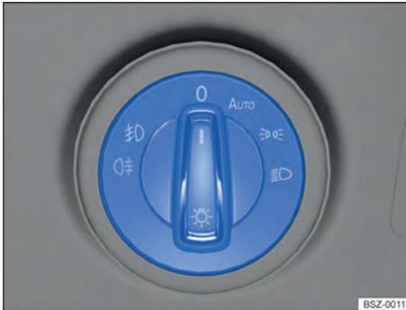
Fig. 82 Junto al volante: mando de las luces (una variante).
