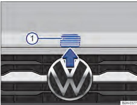
**Fig. 181** Arriba de la parrilla del radiador: palanca de accionamiento para el capó delantero.
