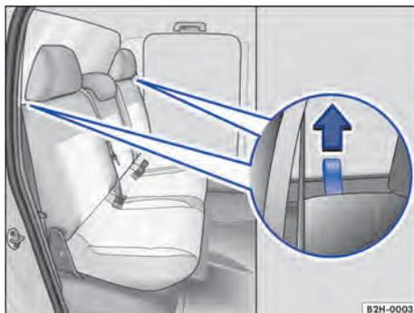
**Fig. 72** Asiento trasero: lazo para desbloquear el respaldo.
