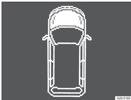
**Fig. 183** En la pantalla del panel de instrumentos: capó delantero abierto o mal cerrado (representación esquemática).
