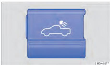
**Fig. 87** En la consola central: tecla de la luz de la superficie de carga.
