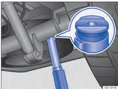
Fig. 218 Colocar el gato debajo del eje trasero.
