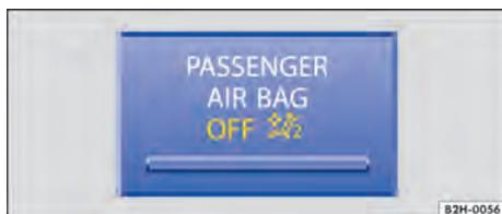
**Fig. 40** En la parte superior de la consola central: testigo de control de la desactivación del airbag frontal del acompañante.
