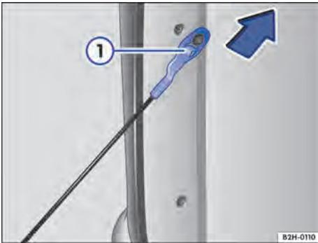
**Fig. 62** Desenganchar el cable de sujeción de la compuerta de carga.
