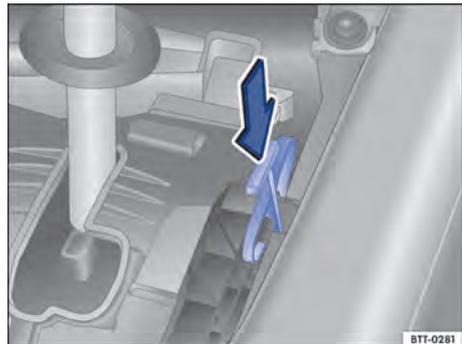
**Fig. 107** Desbloqueo de emergencia de la palanca selectora.
