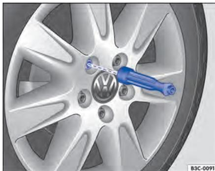
Fig. 219 Cambiar una rueda: desenrosca los tornillos de rueda con el mango del destornillador.
