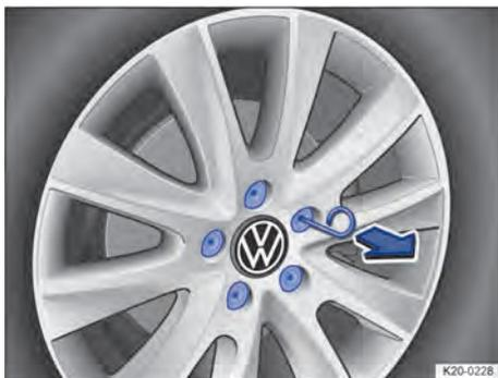
**Fig. 201** Retirar las caperuzas de los tornillos de la rueda.
