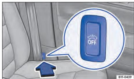
**Fig. 60** Junto al asiento del conductor: tecla para desconectar la vigilancia del habitáculo y el sistema antirremolcado.
