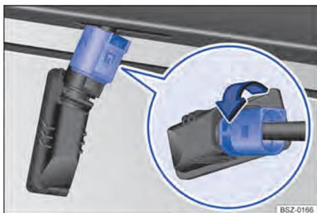
Fig. 166 Luz de matrícula: desmontaje del portalámparas.
