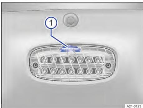
**Fig. 88** Encima de la compuerta de carga: mando de la luz del techo rígido.
