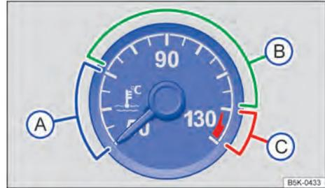
Fig. 14 Indicador de temperatura del líquido refrigerante del motor en el cuadro de instrumentos analógico (representación esquemática).
