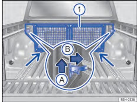
**Fig. 144** En la superficie de carga: montar el elemento divisorio.
