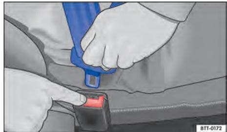
**Fig. 32** Soltar la lengüeta del cierre del cinturón.
