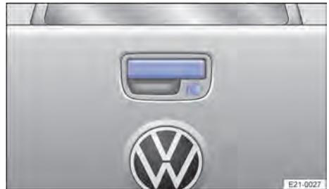
**Fig. 61** En la compuerta de carga: manilla para abrir la compuerta de carga.
