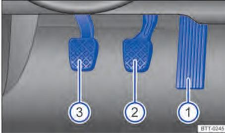
Fig. 98 En la zona reposapiés: pedales en los vehículos con cambio manual.
